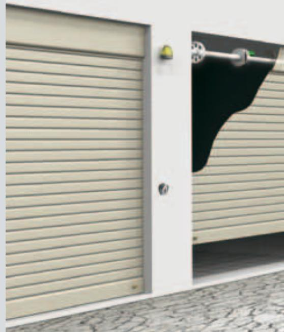
I motoriduttori elettromeccanici serie ZP per serrande avvolgibili reversibili o irreversibili, dispongono di un dispositivo di fine corsa con memoria meccanica, autoregolante in modo da ottenere l'arresto della serranda alcuni centimetri prima che essa incontri il suo fermo meccanico durante la manovra di apertura.
